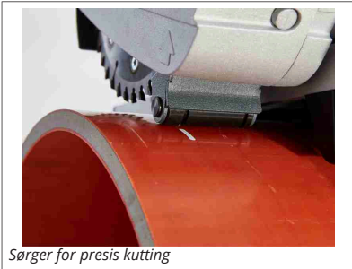
Når du kutter røret får du samtidig en fas på 15 grader i en og samme operasjon.
